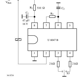
Figure 4a ON/OFF function U 6046 B
