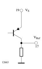
Figure 16. Pin 17  $V_{Ref}$
