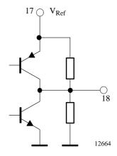
Figure 17. Pin 18 FM<sub>out</sub>
