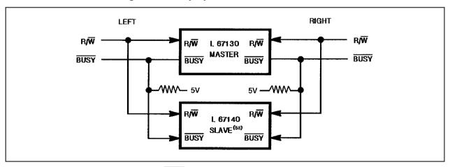
Note: 58. No arbitration in L 67140 (SLAVE). BUSY IN inhibits write in L 67140 (SLAVE).
