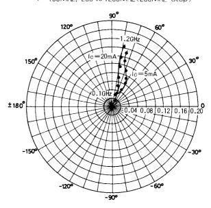
S22e: V<sub>CE</sub>=10V f=100MHz, 200 to 1200MHz (200MHz step)
