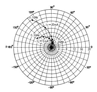
S12e: V<sub>CE</sub>=10V f=100MHz, 200 to 1200MHz(200MHz step)
