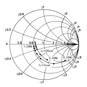
S21e: V<sub>CE</sub>=10V f=100MHz, 200 to 1200MHz(200MHz step)
