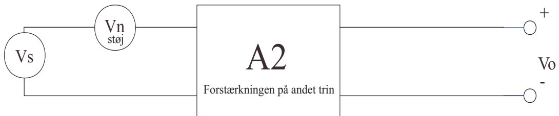
Figur 6.19 Introduktion af støj på det sidste forstærkertrin.
