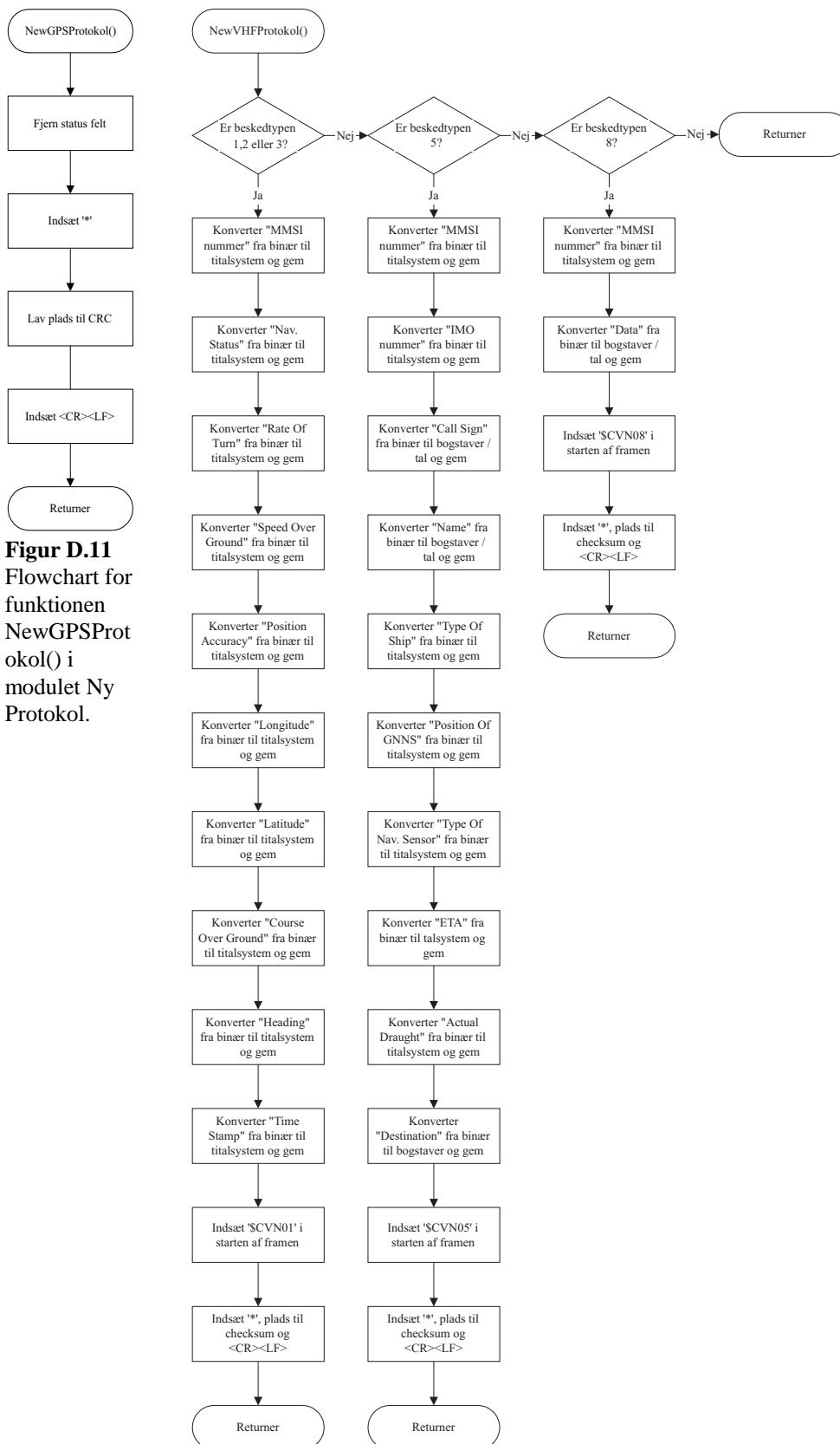
Figur D.12 Flowchart for funktionen NewVHFProtokol() i modulet Ny protokol
