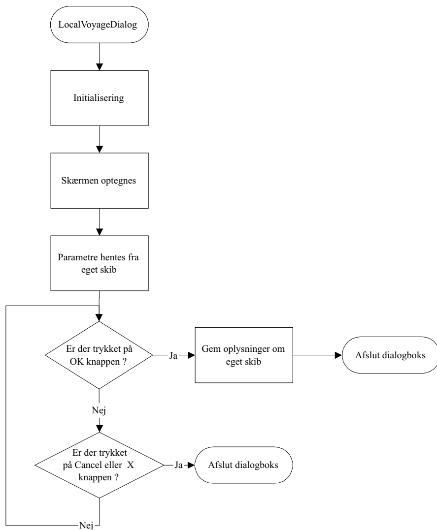
Figur F.9 Dialogboks for eget skib. De indtastede data gemmes, hvis der trykkes på knappen, OK og ignoreres, hvis der trykkes cancel. Under opstart af dialogboksen hentes de aktuelle data fra eget skib. Den sidste del af flowchartet, hvor der forekommer nogle valg, aktiveres kun, hvis der trykkes på en knap.
