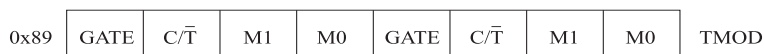
Figur A.7 Placering af- og navnene på de forskellige bit i TMOD
