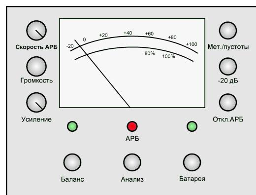
Кнопка «**-20 дБ**» снижает общую чувствительность прибора в несколько раз. Это бывает необходимо при значительной засоренности почвы различными металлическими предметами.
