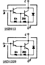
Unit (resistance :  $\Omega$ , capacitance : F)
