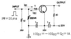
Unit (resistance :  $\Omega$ , capacitance : F)
