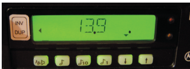
Slika 11b - Fotografiji predelanega TRX, prikaz napetosti napajanja in frekvence
