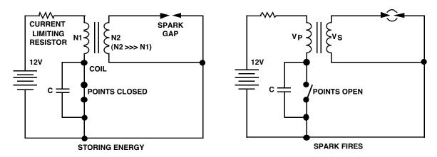
FIGURE 27. SPARK FIRING CIRCUIT
