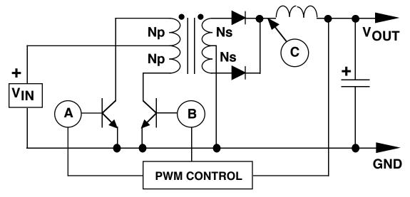
FIGURE 35. PUSH-PULL CONVERTER
