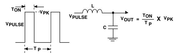
FIGURE 28. BASIC PRINCIPLES OF PWM
