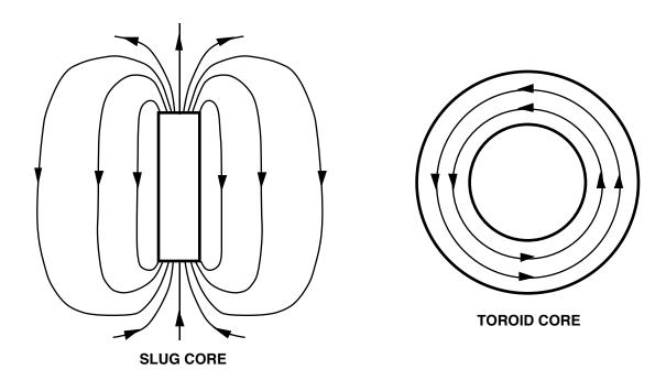
FIGURE 43. FLUX PATHS IN SLUG AND TOROID CORES
