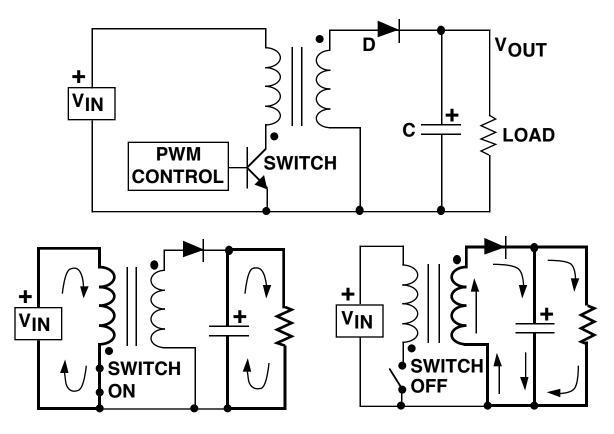
FIGURE 33. SINGLE-OUTPUT FLYBACK REGULATOR
