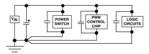
FIGURE 42. EXAMPLE OF GOOD GROUNDING
